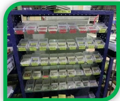
【先入れ先出しの仕組みのボルト棚】
